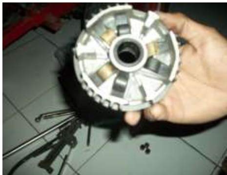
Gambar. 4 Pemasangan kombinasi roller 9 dan 11 gram
