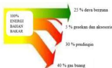
Gambar 3. Keseimbangan energi pada motor bakar (Winarno dan karnowo 2014)
