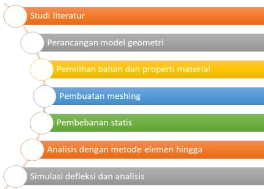
Gambar 3. Tahapan penelitian Pengaruh Pembebanan Statis Pada Struktur Rangka CNC Laser CO2
