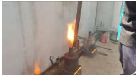
Gambar 9 pengukuran tinggi api
