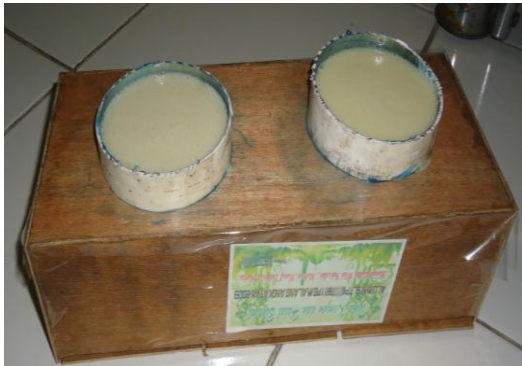
Gb.5 Cetakan blank roda gigi transportir
