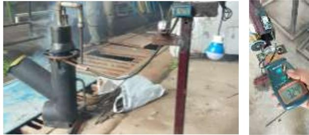
Gambar 3.3 Proses Pengujian Ketel Uap Sampah
